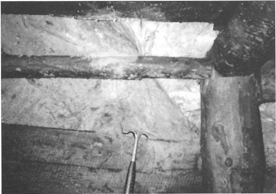
Abb. 2: Mommel, Richtstrecke NW im Niveau Tiefer Stollen, Grenze Anhydrit (rechts) zum Zechsteinkalk (links)
