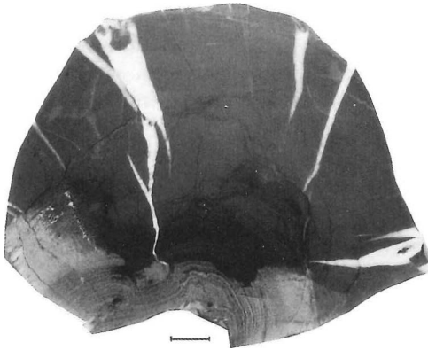
Abb. 3: Angeschliffener Sattelscheitel aus den engspannig gefalteten Ceratiten-Schichten des Kalksteintagebaus der Fa. Rena. Der obere Scheitelrand wird von zahlreichen Scheitelklüften, der Sattelnern von Stylolithen (S) durchsetzt (Maßstab 1 cm).
