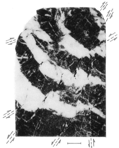
Abb. 2: Ausschnitt aus einer stark rupturierten Trochitenkalkbank mit faserkalzitgefüllten Fiederklüften. Diese werden von diskreten Gleitflächen versetzt, die teilweise an Stylolithen gebunden sind und ihrerseits zum Aufreißen neuer Fiederklüfte führten (Maßstab 1 cm).
