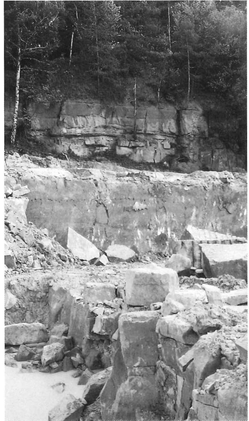
Abb 1: Sandsteingewinnung im Kammerbruch auf dem Seeberg bei Gotha
