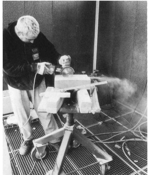
Bild 6: Sandstein - Bearbeitung unter lufttechnischer Versorgung Fotos 5 und 6: G. MEIER, Karlsruhe
