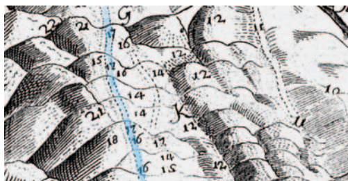
Abb. 8: Graphische Darstellung der geologischen Verhältnisse im Raum Königsee (K) – Gehren (G). Die Darstellung Füchselfs entspricht annähernd den heutigen Erkenntnissen und zeugt von einer jahrelangen intensiven Kartierungsarbeit im Gelände. Beachtlich die Grenzziehung Zechsteinkonglomerat – Ordovizium (Verlauf entlang der Markierung 17) und die vermutete Störung in 14.
