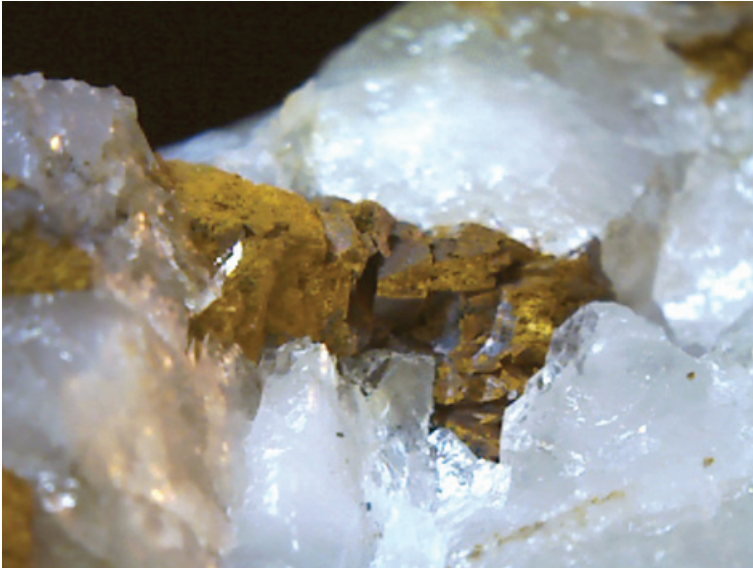
Abb. 5: Pseudomorphose von erdigem Limonit nach vermutlich Siderit oder Ankerit in Hohlräumen von Quarz. Vergrößerung etwa 20mal. Fundort: Wallendorfer Weg nahe Katzhütte/ Thür.
