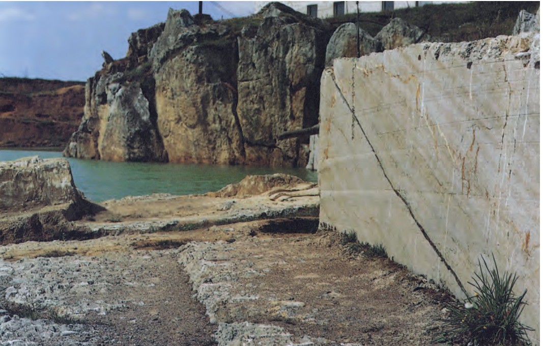
Abb. 22: Schubertsbruch bei Pahren, Abbaustelle mit Seilsägeschnitt
