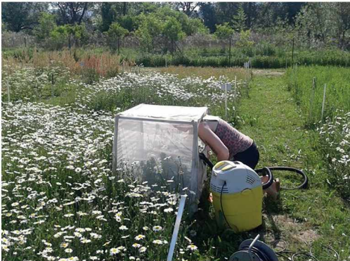
Abb. 10: Aus einem auf die Experimentalparzelle gesetzten Gazezelt werden mit einem Industriestaubsauger die Arthropoden gesaugt, Sommer 2012. Foto: A. Ebeling.
