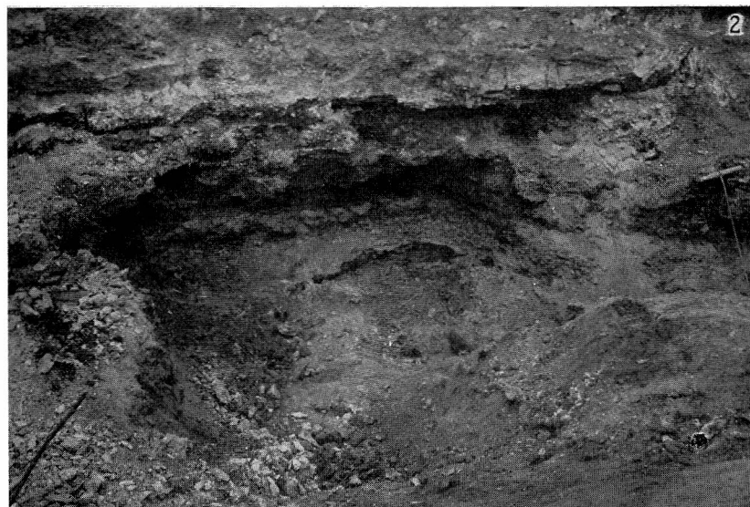
Abb. 26. Oststoß des Schlingmannschen Bruches, 1930 (von oben), 50 cm Abraum - 50 cm Sinterkalk - 20 cm Piepstein - 3 cm Brauneisenfällungszone - 160 cm sehr lockerer, von Brauneisen gefärbter Grott - 3 cm Mergelband - 60 cm Grott - 30 cm Sinterkalk.
