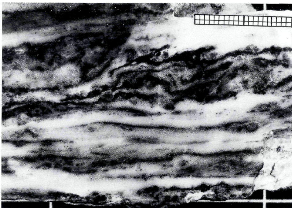
Abb. 3: Großanschliff des erzführenden Calcitmarmores von Falpetann. Marke 2×20 mm. Weiß bis weißgrau ist reiner Calcit, licht- bis hellgrau erzpigmentierter Calcit, grau einzelne Quarzaggregate und grauschwarz bis schwarz sind Erzfeinlagen. Deutlich zu sehen eine Wechsellagerung von karbonatischen und erzführenden quarzitischen Lagen, sowie in der oberen Bildhälfte eine gemeinsame Fältelung und Scherung von Erz- und Karbonatschichten.
