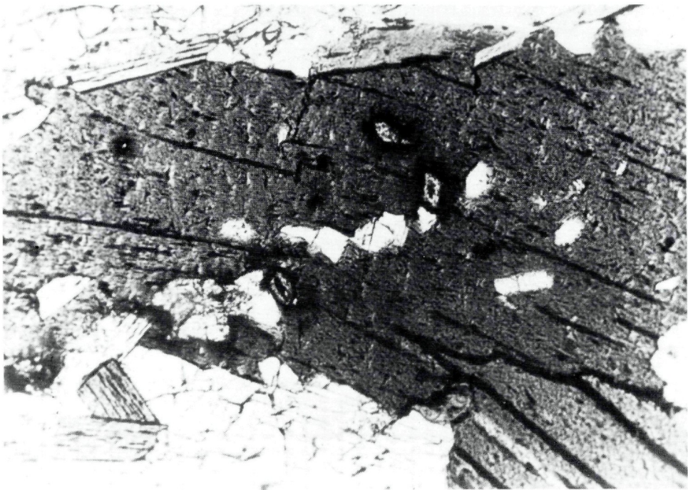
Abb. 2: Augengneis vom Felbertauern: Dünnschliff, Bildausschnitt 1,4 x 0,9 mm, Nicols parallel. Zirkon (hohes Relief) mit pleochroitischen Höfen in Biotit (dunkelgrau).
