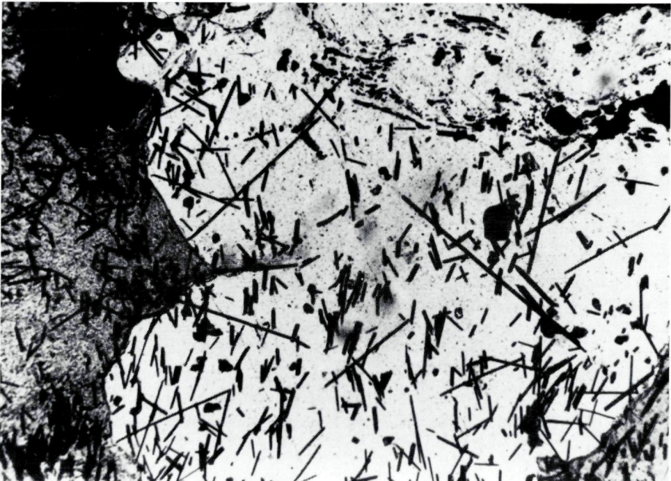
Abb. 10: Manganminerale in Quarz und Karbonat von der Hutteralm-Ost: Dünnschliff, Bildausschnitt 0,7 x 0,47 mm, Nicols + . Kryptomelan-, Coronadit-, Hollanditnadeln (schwarz) in Quarz (weiß) und Karbonat (grauweiß bis schwarzgrau).
