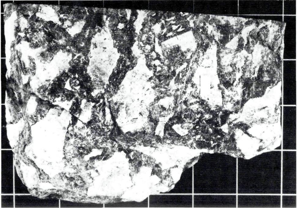
Abb. 4: Syndiagenetische Deformationsbreccie mit wegsamkeitsbevorzugter Mineralisation im Fugennetz. Weiße bis lichtgraue Fragmente: Alpiner Muschelkalk; dunkel- bis schwarzgraue Fugenfüllung: Schalenblende, Bleiglanz und Pyrit.
