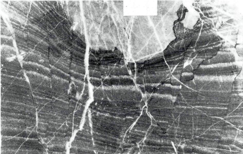
Abb. 6: Geopetale Anlagerung von Erzschlamm (dunkelgrau-feingeschichtet) im Lösungshohlraum des Alpenen Muschelkalkes. Interne Resedimentation von Kalkbruchstücken (hellgrau), die aus der Decke des Hohlräumes stammen. Syndiagenetische Verstellung der liegenden Feinschichten. Bergbau St. Veit (Großanschliff; Marke 10 x 5 mm).
