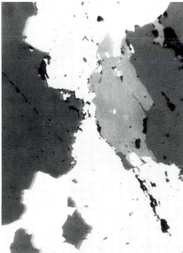
Abb. 3 Vererzungstypus der Generation III. Bleiglanz (weiß) wird von Kupferkies (weißgrau), Eisenkarbonat (mittelgrau) und Quarz (dunkelgrau) verdrängt. Ausbrüche (schwarz). Polierter Anschliff, Nicols //, Bildausschnitt 1,2 x 0,7 mm.
