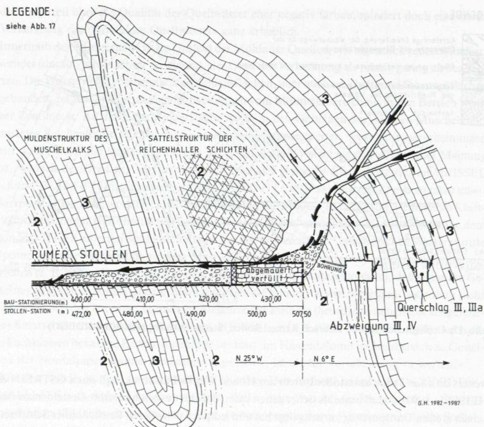
Abb. 18: Geologischer Schnitt Verbruch Rumer Stollen, Station 505.00 (Interpretation aufgrund der neuen Erkenntnisse unter Mithilfe der hydrogeologischen Verhältnisse)
