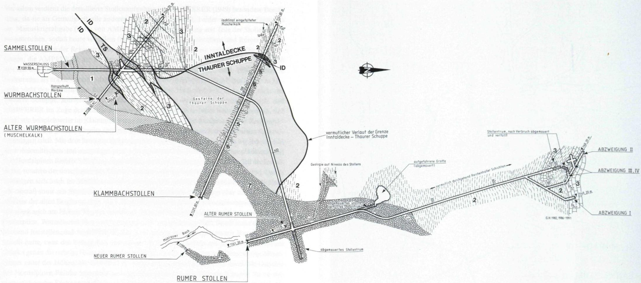
Abb. 11: Geologischer Horizontalschnitt im Niveau der Stollensohle
