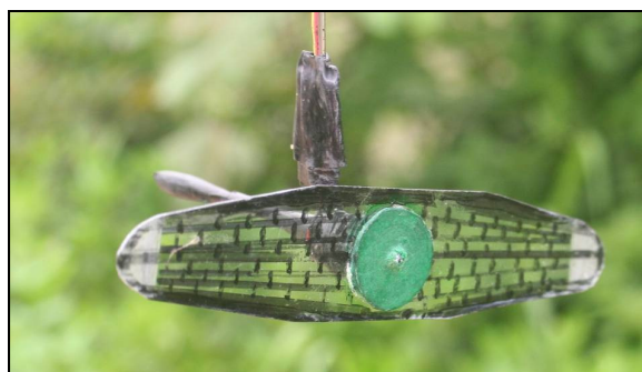
Abb. 19: Ishizawa's Libellenpropeller, elektrisch betrieben
