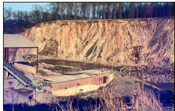
Abb. 23: Steinbruch Vorhalle (1987, noch in Betrieb): „Kersberg-Wand“ und Brecheranlagen zur Zerkleinerung der abgebauten Ziegelschiefer (vorn links). Foto: L. Koch.
