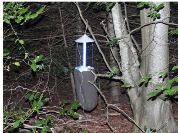
Abb. 8: Exponierte Lebendfalle mit 15 W superaktinischer Leuchtstoffröhre (Hängemodell nach Weber).
