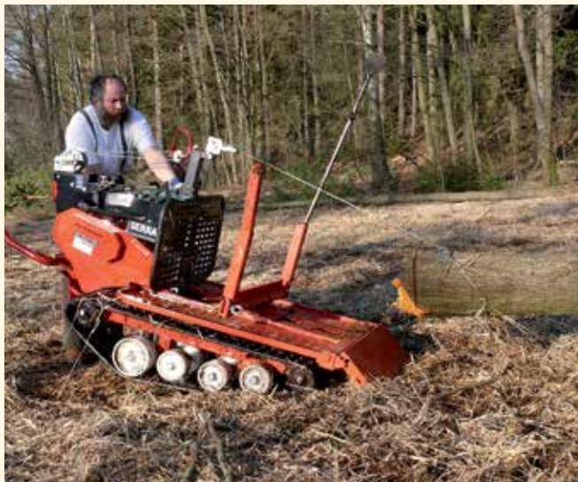
Mit dem „eisernen Pferd“ können mittels einer Seilwinde schonend Baumstämme aus empfindlichen Lebensräumen wie Mooren oder Quellbereichen entfernt werden - ideal für Renaturierungsarbeiten
