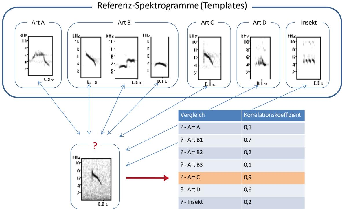
**Abb. 3:** Funktionsschema der Spektrogrammkorrelation. Große Ähnlichkeiten in den Spektrogrammen spiegeln sich in einem hohen Korrelationskoeffizienten wieder. - *Functional diagram of spectrogram correlation. Great similarities in the spectrograms are reflected in a high correlation coefficient.*
