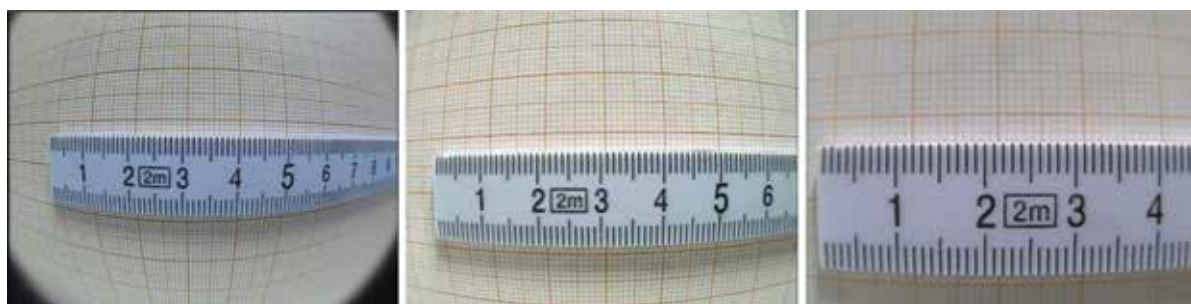
Abb. 4: Vergleich der Bildweiten und Verzerrungen von CCD-Kameras (links und Mitte) sowie von einer CMOS-Kamera bei einem Objekt Abstand von 45 mm zur Linse. – Comparison of image width and distortions between the two CCD-cameras (left and centre) and the CMOS-Camera (right) for an object 45 mm from the lens.
