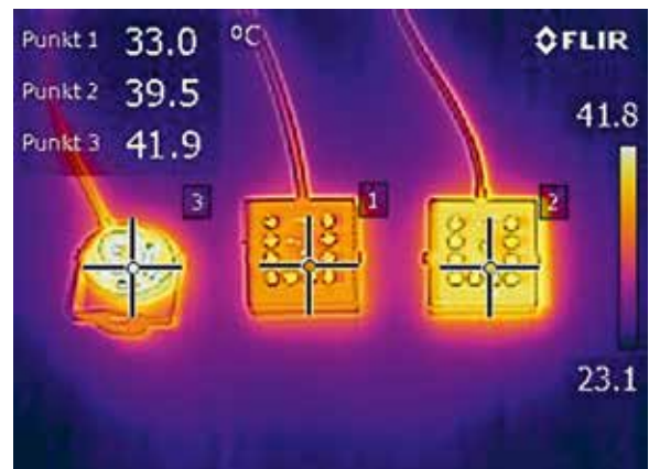
Abb. 11: CMOS-Kamera (links) im Vergleich zu CCD-Kameras (Mitte und rechts) nach einer Betriebsdauer von 45 Minuten in einem 23 °C warmen Raum ohne Zugluft. Die CMOS-Kamera wird mit annähernd 42 °C am wärmsten. – Thermographic image illustrating differences in heat emission between the CMOS-camera (left) and the two CCD-cameras (centre and right) after 45 minutes of use at a room temperature of 23°C with no ventilation.
