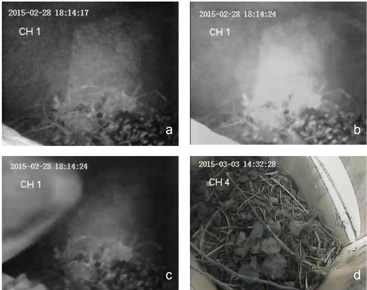
Abb. 8: In der Dämmerung kann die Bildqualität in Nistkästen sehr flau und kontrastarm sein (a, b). Passiert ein Tier das Einflugloch, wird durch die plötzliche Dunkelheit die IR-Beleuchtung ausgelöst (c). Je nach Sonnenstand entstehen durch das Einflugloch wie bei einer Camera obscura Sonnenprojektionen an der Kastenwand, welche die Bewegungserkennung auslösen (d). - Twilight may cause poor image quality with typically dull and flat images (a, b). Animals entering nest boxes via the entrance hole cause an automatic change from daylight settings to IR lighting in the camera (c). Furthermore, the position of the sun in relation to the entrance hole can cause effects similar to a camera obscura with projections of the sun onto the inside walls inducing motion detection in the camera (d).
