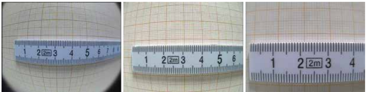
Abb. 4: Vergleich der Bildweiten und Verzerrungen von CCD-Kameras (links und Mitte) sowie von einer CMOS-Kamera bei einem Objektabstand von 45 mm zur Linse. – Comparison of image width and distortions between the two CCD-cameras (left and centre) and the CMOS-Camera (right) for an object 45 mm from the lens.
