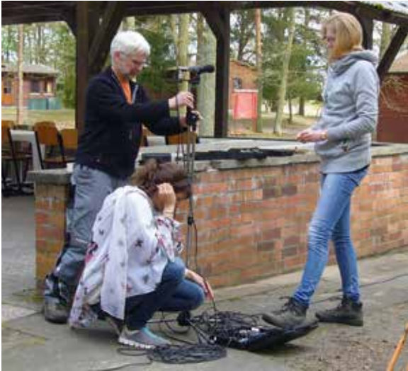
Aufbau der Mikrofon-Messtrecke zur akustischen Lokalisation und Schallpegelmessung. Foto: Ommo Hüppop
