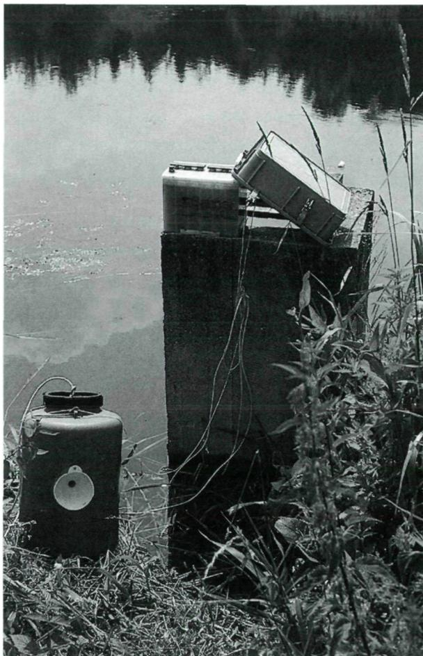
Foto Nr. 7: Lichtfalle zum Fischbrutfang (mit Batterie auf dem Mönch)
