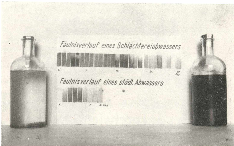
Abb. 2. Faulversuch in Flaschen
