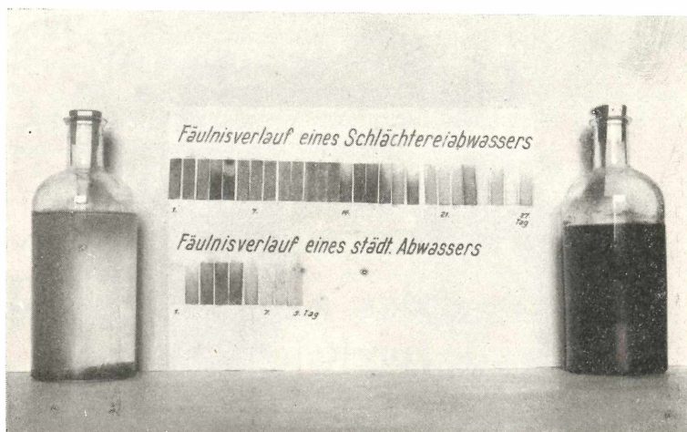
Abb. 2. Faulversuch in Flaschen
