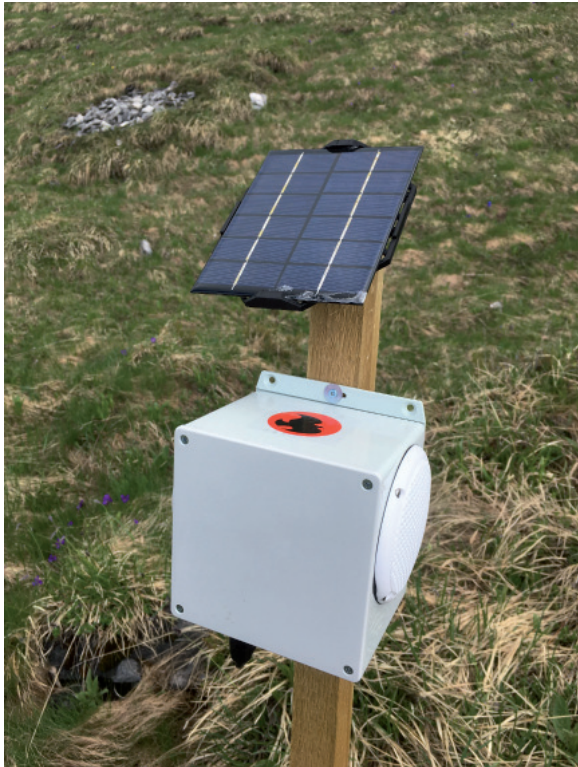
Abb. 3: Solargespiesene Playbackstation zum Abspielen der Braunkehlchengesänge. – Playback station powered by solar energy to broadcast Whinchat songs (Photo: © M. VÖGELI).
