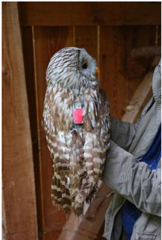
Abb. 8: Prototyp des GSM-Senders im Volierentest. Der Sender wurde am Becken des Kauzes montiert. Vorteil dieser Methode ist es, dass der Sender beim Öffnen nur einer Sollbruchstelle umgehend abfällt (der schlechte Gefiederzustand weist diesen Kauz als einen der wiedereingefangenen Käuze aus, Foto: C. Leditznig)
