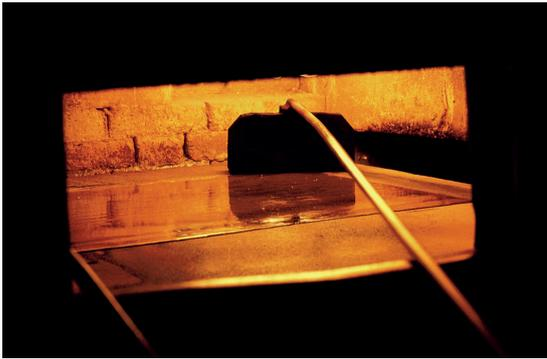
Abb. 9: Strecken des Glaszylinders zu einer flachen Glastafel
