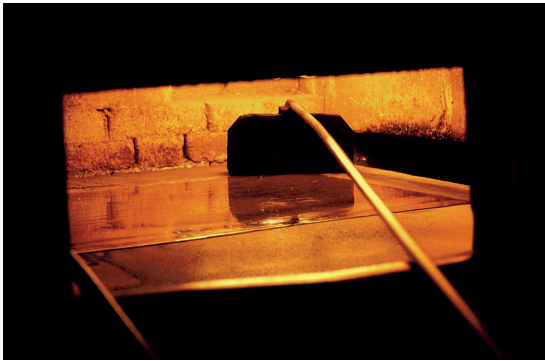
Abb. 9: Strecken des Glaszylinders zu einer flachen Glastafel
