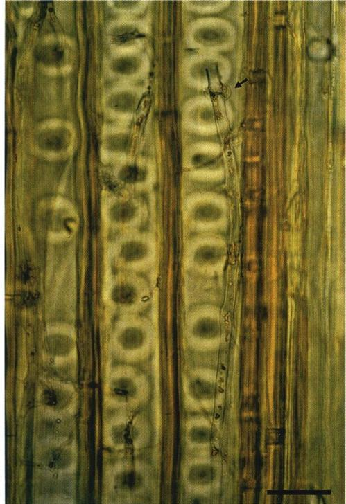
**Abb. 4:** Radialschnitt von Fichtensplintholz mit Infektion durch *S. sanguinolentum*. Skeletthyphye mit Doppelschnalle (Pfeil) in einer Tracheide, Anfärbung mit Lugolscher Lösung. Balken = 20 µm.
