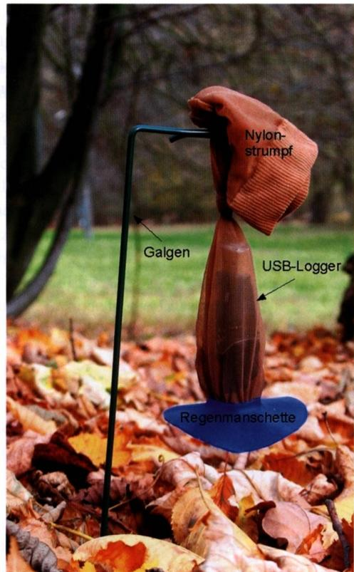
Abb. 12: Aufstellung des Lufttemperatur-/Luftfeuchte-Loggers im Gelände.
