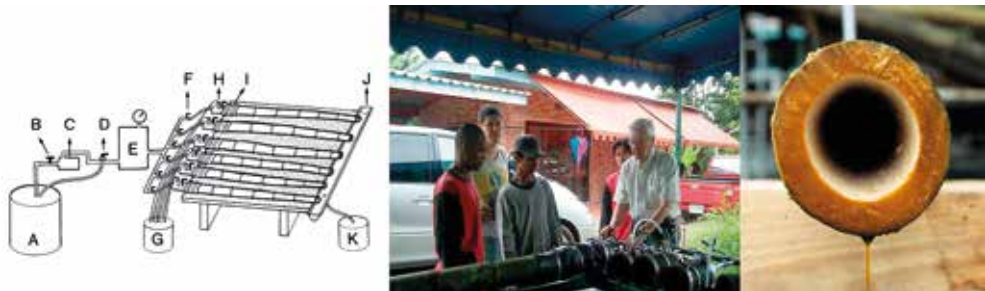
Abb. 15: Saftverdrängungsverfahren zur Druckimprägnierung von Bambushalmen Zeichnung, Fotos: W. LIESE
