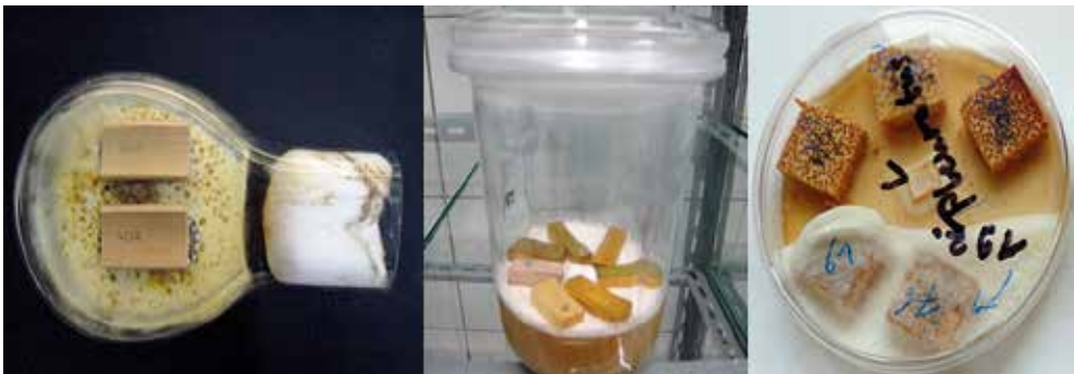
Abb. 6: Kulturgefäße zur Bestimmung des pilzbedingten Masseverlustes bei Bambus und Palmenholz; links: Kolleschale mit Coniophora puteana und Bambusproben, Mitte: Weckglas mit Pleurotus ostreatus und Bambusproben, rechts: Petrischale mit P. ostreatus und Palmholzproben
