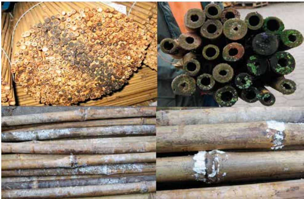
Abb. 4: Verschimmelte Bambushalme nach Überseetransport aus Asien Fotos: aus TANG 2013
