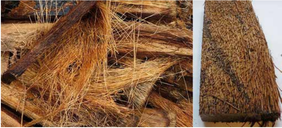
Abb. 5: Während der Lagerung in Malaysia verfaultes Palmenholz
