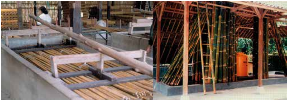
Abb. 14: Schutzbehandlung von Bambus durch Tauchen (links) und durch das Diffusionsverfahren (rechts) Fotos: W. LIESE
