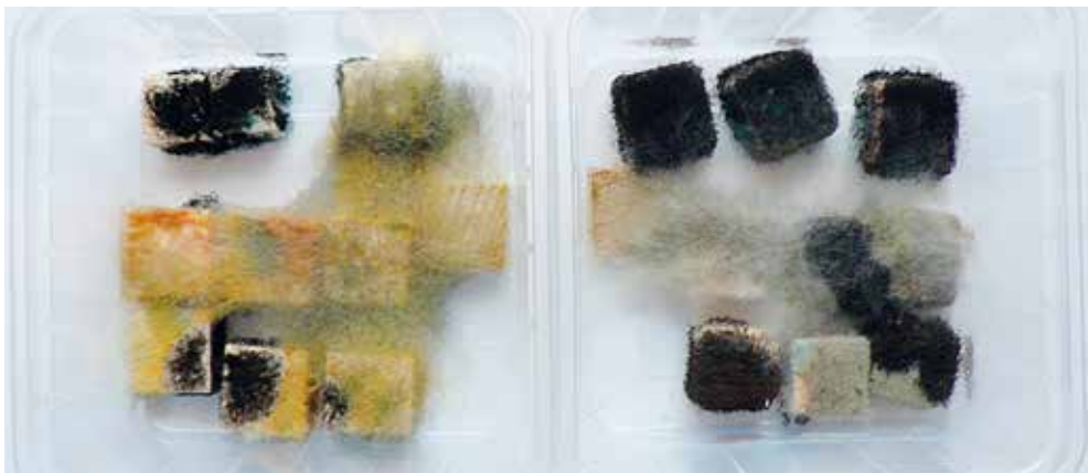
Abb. 13: Schimmelpilzbewuchs auf ungeschützten Dattel- (links) und Ölpalmenklötzchen (rechts) nach 2 Wochen Inkubation Fotos: O. Schmidt
