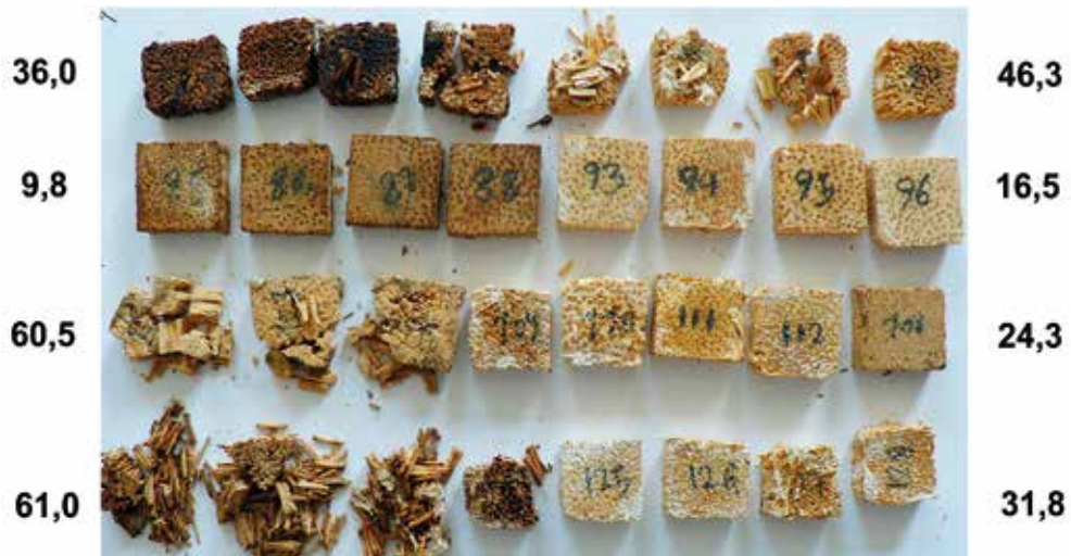
Abb. 7: Dattel- und Ölpalmenklötzchen nach 8 Wochen Inkubation mit Coniophora puteana (links) und Pleurotus ostreatus (rechts); 1. Reihe: Dattelpalme, 2. Reihe: Ölpalme, Stammbasis, 3. Reihe: Ölpalme, Stammmitte, 4. Reihe: Ölpalme, Stammsspitze; Zahlen links und rechts: Masseverluste als Mittelwerte von je 4 Proben in %
