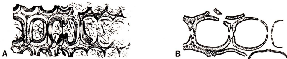
Abb. 2: Destraktions- und Korrosionsfäule.
