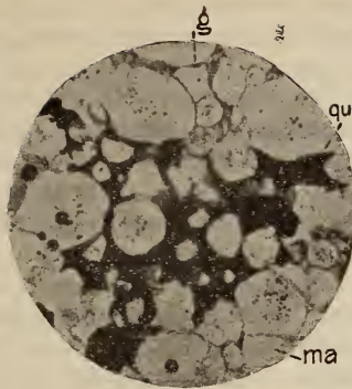
Textfig. 3. Magnetitarmer Quarzfels mit lückenfüllendem Granat. Quarz, angefüllt mit Magnetitpartikelchen. g = Granat.
