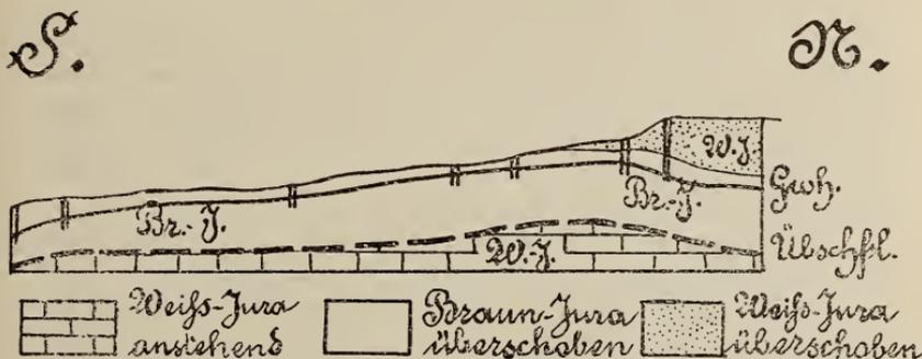
Fig. 3. Profil durch den Grundwasserhorizont (Gwh.) von Hertsfeldhausen.
