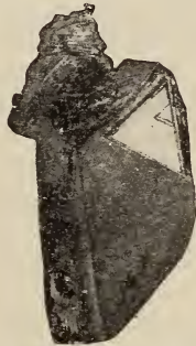
Fig. 4. Ein 0,7 mm messendes Graphitaggregat bei 40 maliger Vergrößerung.
