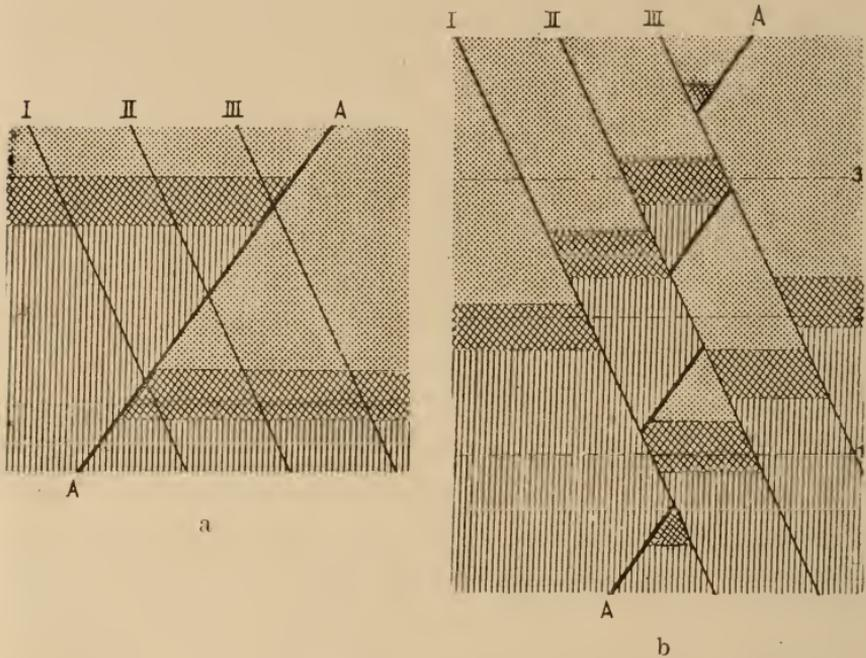
Fig. 2. Schematische Profile sich kreuzender Kompressionsverwerfungen.
