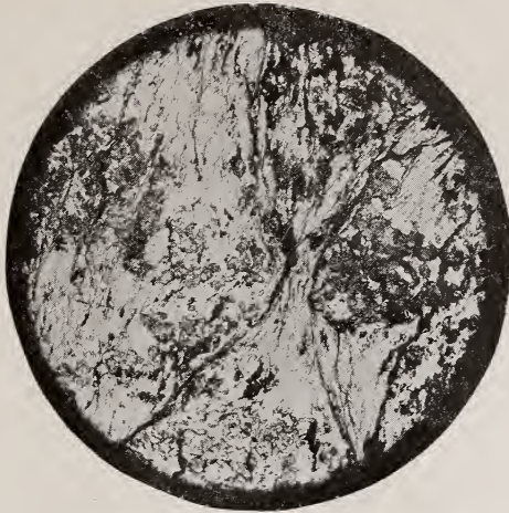
Fig. 1. „Augen“ im Kordieritkorundfels, von stark in Kayserit umgewandelten Korundkristallen erfüllt (18 fach vergrößert).
