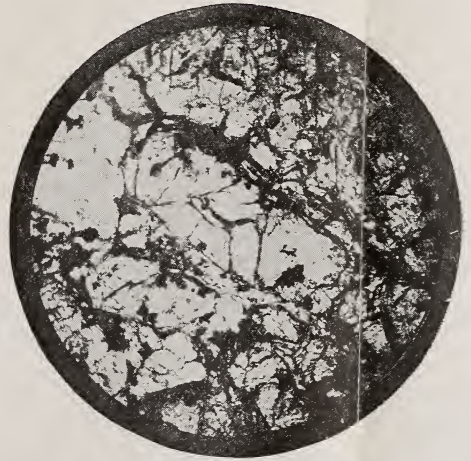
Fig. 3. Korundkristall im Korundfels mit Rissen nach R (33 fach vergr.).
