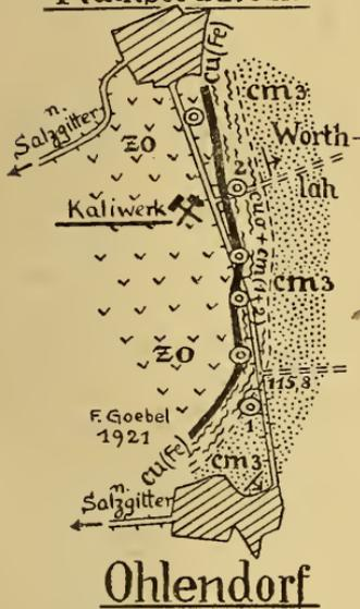
Fig. 1. Geologische Skizze des vortertiären Untergrunds auf dem Ostflügel des Flachstökheimer Salzaufbruches.
