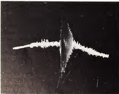
Abb. 4. Oszillogramm des Echos von Myotis myotis in 40 cm Entfernung vom Reflektor (Glasplatte)
