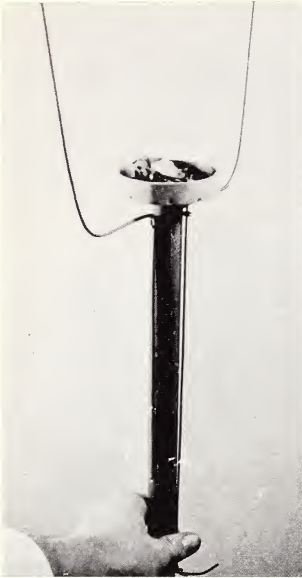
Abb. 2. Handraschel-Apparat mit Gabel. Mit ihm kann an jeder beliebigen Stelle im Raum ein Geräusch erzeugt werden
