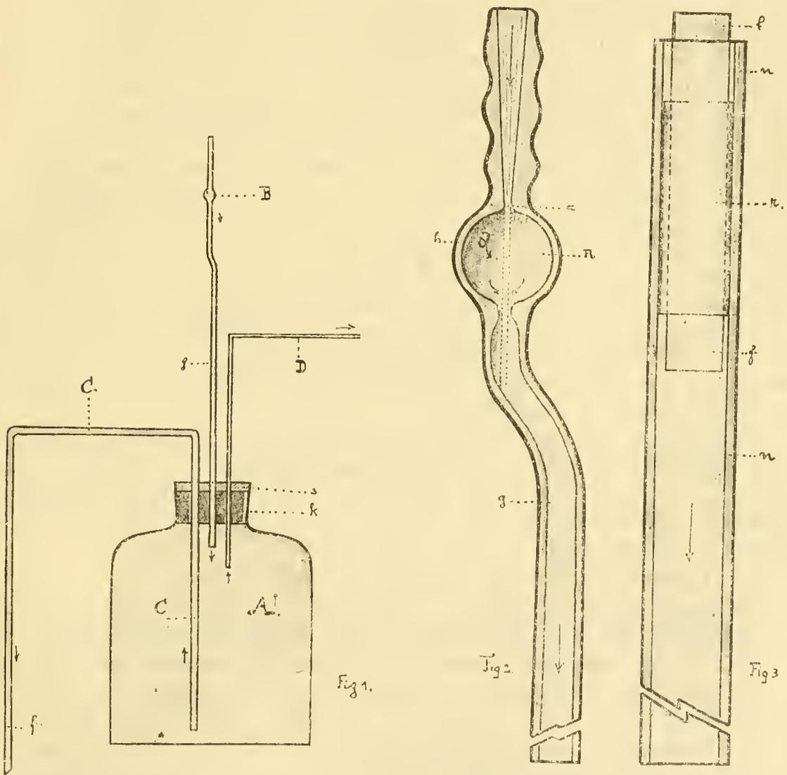
des Wassers und treibt dieses durch die Röhre *C* hinaus (Fig. 1). Diese besitzt eine Weite von 10—12 mm, reicht bis zum Flaschenboden, durchsetzt luftdicht den Pfropfen und biegt dann rechtwinklig ab, um sich in der beliebig langen Abflußröhre *f* fortzusetzen. Diese muß mit der Steigröhre *C* einen Heber bilden, da der Luftdruck in der Flasche nicht genügt, den Widerstand einer langen Leitung
