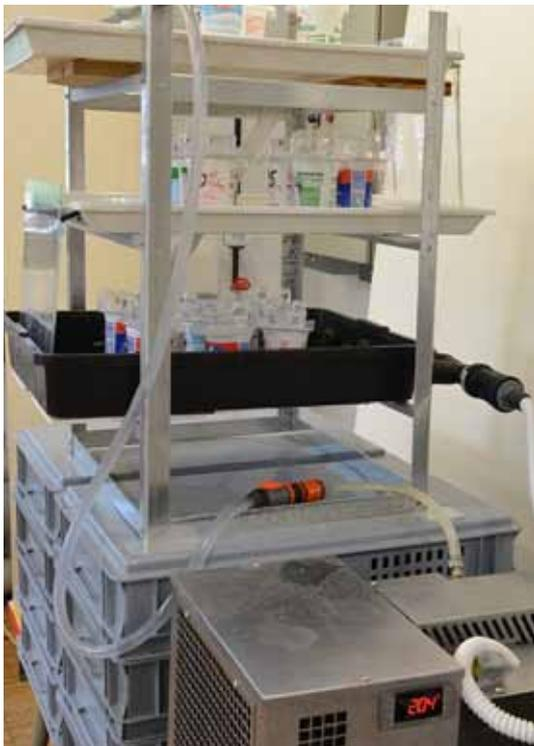
Das Herzstück – und gleichzeitig der teuerste Bestandteil – der Eintagsfliegen-Zuchtanlage ist das Kühlaggregat (im Vordergrund).
