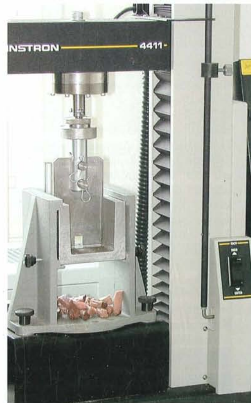
Bei der Scherkraftmessung wird die Zartheit des Fleisches objektiv beurteilt.
