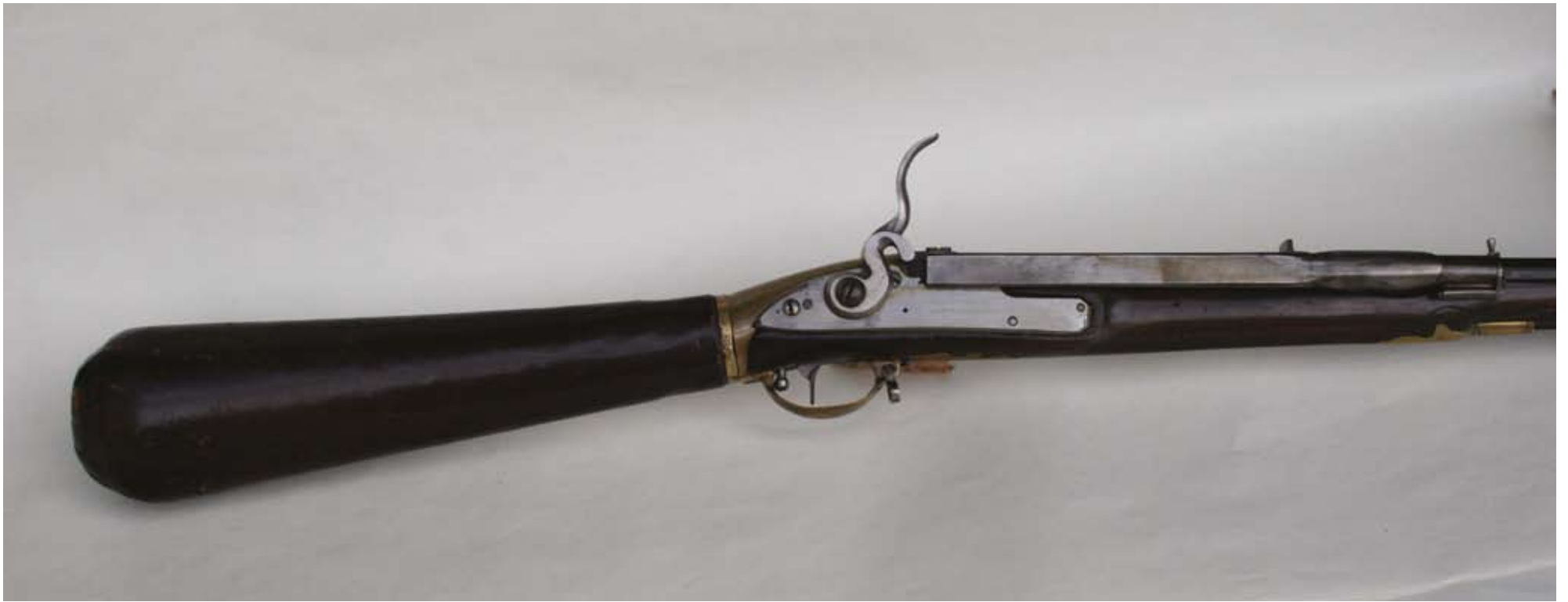
Militär-Repetierwindbüchse mit angeschraubter „Luftflasche“ als Druckluftbehälter und seitlich am Lauf montiertem Magazin für 20 Bleikugeln, erfunden und ausgeführt von Bartolomeo Girandoni aus Cortina d'Ampezzo.
