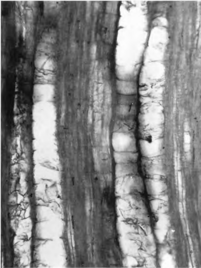
Abb.12: Radialschnitt. Große Frühholzgefäße von Castanea sativa Mill. mit Thyllen und kurzen Zellelementen. Rechts kleine Spätholzgefäße, darüber schwer erkennbar die homozellularen Holzstrahlen. 120 x.
