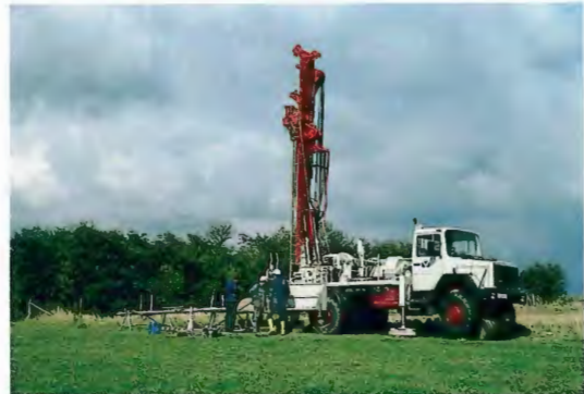
Abb. 22 Brilon-Nehden / Hochsauerlandkreis. Steinbruch Henke. Einsatz von schwerem Bohrergerät zur Ermittlung der Ablagerungsmächtigkeiten.
