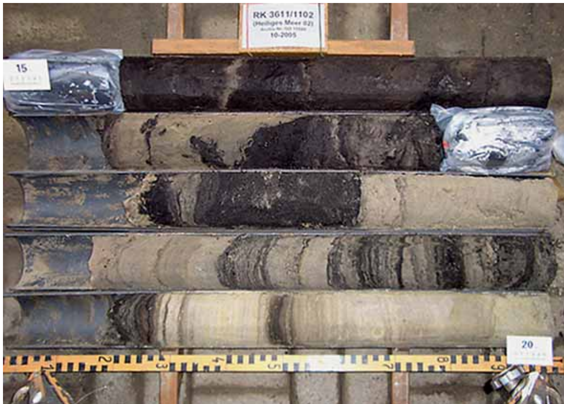
Abb. 17: Eemzeitliche Ablagerungen in der Rammkernbohrung 3611/1102 (Teufenintervall: 15 - 20 m u. GOK)..
