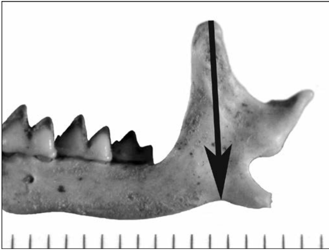
Abb. 7: Teil des linken Unterkiefers der Wasserspitzmaus, Neomys fodiens . Der Pfeil demonstriert die Messung der Coronoidhöhe. Einteilung des Maßstabes 0,5 mm.
