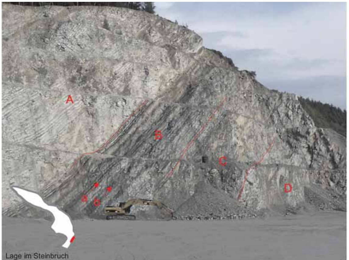
Abb. 5: Steinbruch DIMAC, Südostwand, überkippte Lagerung, A obere Brochterbeck-Formation, B Hesselstal-Formation, C Büren-Formation, D basale Oerlinghausen-Formation. a Cenomanium/Turonium-Grenze, b Watinoceras -Event, September 2010.
