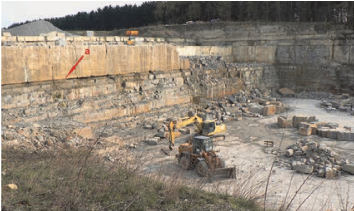
Abb. 10: Steinbruch Stelbrink, Niederntudorf, Salder-Formation mit a unterer Werksteinbank des Soester Grünsandstein, Oberturonium, obere Subprionocyclus neptuni -Zone und untere Prionocyclus germari -Zone, Gewinnung von Naturbausteinen, Herkunftsort u.a. der restaurierten Außenmauerwerke des Paderborner Doms und der Kaiserpfalz, TK 25 Blatt 4318 Borchon, Rechts 3478595, Hoch 5721260, NN + 190 m.
