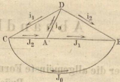
und lässt  $D$  in die Grundfläche fallen, so nimmt die Verzweigung die Form (Fig. 2) der Kirchhoff'schen Brücke an.
