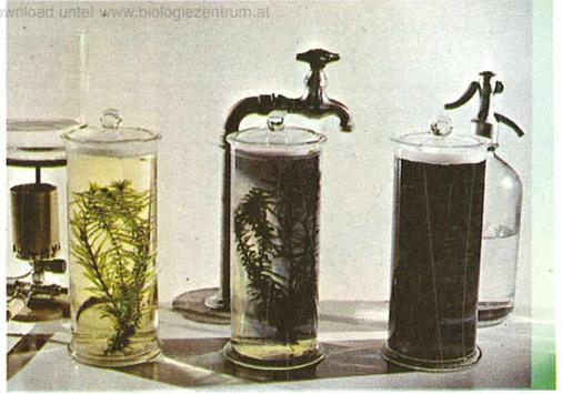
Abb. 6 b: Versuch zur Abhängigkeit der Sauerstoffentwicklung vom  $\text{CO}_2$ -Angebot: die Indigokarminlösungen wurden aus Wassersorten mit steigenden  $\text{CO}_2$ -Gehalten bereitet.
