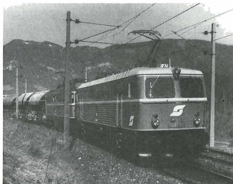
Eine der neuen österreichischen Thyristor-E-Loks der Reihe 1044 bei Eichberg
